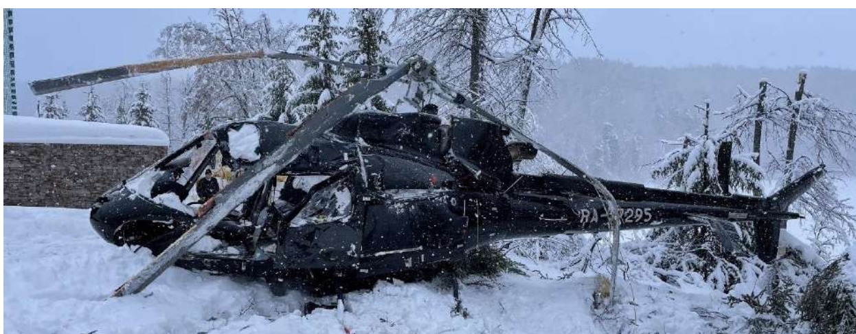
Рис. 3. Вид повреждений ВС после подъема на шасси
